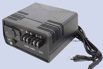
ART.-NO.: EGHW824 Netzteil 100W zum Anschluss eines 24V Gerätes an 110-240V mit Vorrangschaltung. Maximal 10 A. Power Supply 100W to connect a 24V device to 110-240V with priority energy circuit. Maximum 10 A
